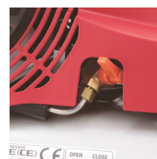
Purge à portée sphérique
